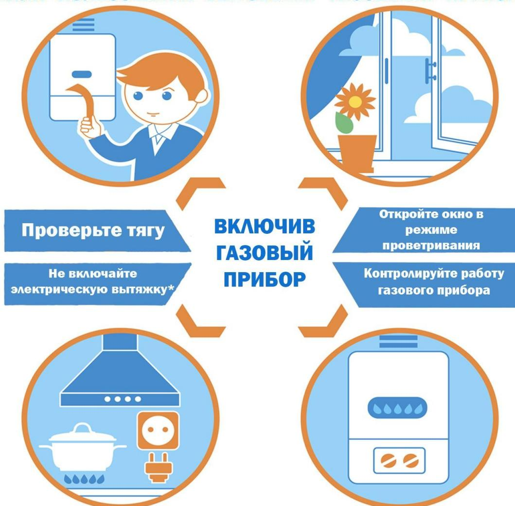
**\*Включение принудительной вытяжки над плитой или электровентилятора в вентканале при отсутствии притока воздуха (создает дополнительное разряжение, вследствие чего происходит опрокидывание тяги в дымоходе)**
